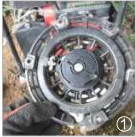
↑08.13揚水ポンプの始動 ロープがボロボロで、エンジンを始動できなくなった
