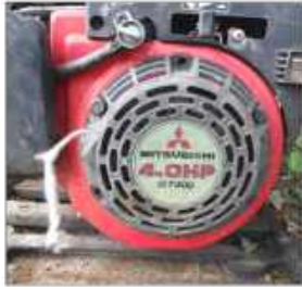
↑08.13揚水ポンプの始動 ロープがボロボロで、エンジンを始動できなくなった
