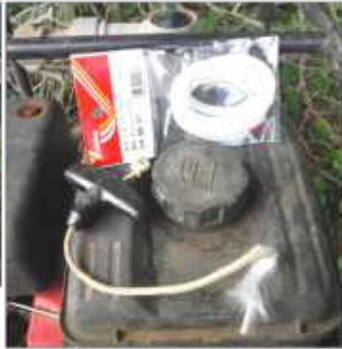
↑08.13揚水ポンプの始動 ロープがボロボロで、エンジンを始動できなくなった
